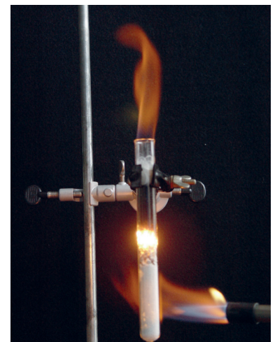
Abb. 3. Ein mit einem Oxi-Reiniger betriebener Hochofen im Reagenzglas: Der Reiniger im Reagenzglas setzt beim Erhitzen Sauerstoff frei. Darüber befindet sich Kohle mit einigen Stückchen Eisenoxid. Der Kohlenstoff verbrennt mit dem Sauerstoff zu \text{CO}_2 (das helle Leuchten in der Mitte), dieser setzt sich dann mit dem verbliebenen Kohlenstoff zu \text{CO} um, welches das Eisenoxid reduziert. (Foto: Marco Rossow)
